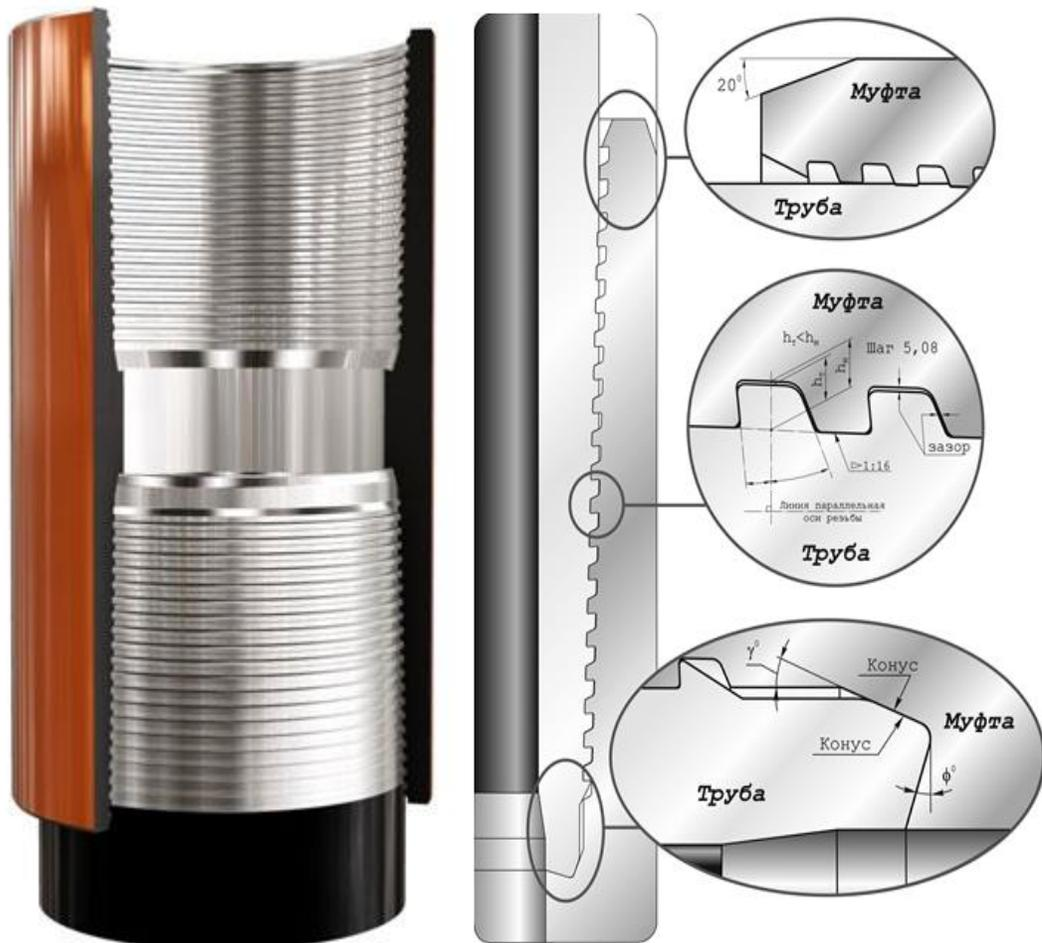
**TMK UP PF** — соединение обсадных труб для крепления наклонно-направленных нефтяных скважин с высокой интенсивностью искривления ствола. Обеспечивает высокую герметичность при сложных условиях эксплуатации (значительных изгибающих, сжимающих, растягивающих нагрузках, крутящем моменте, агрессивных средах), обеспечивает газогерметичность.
